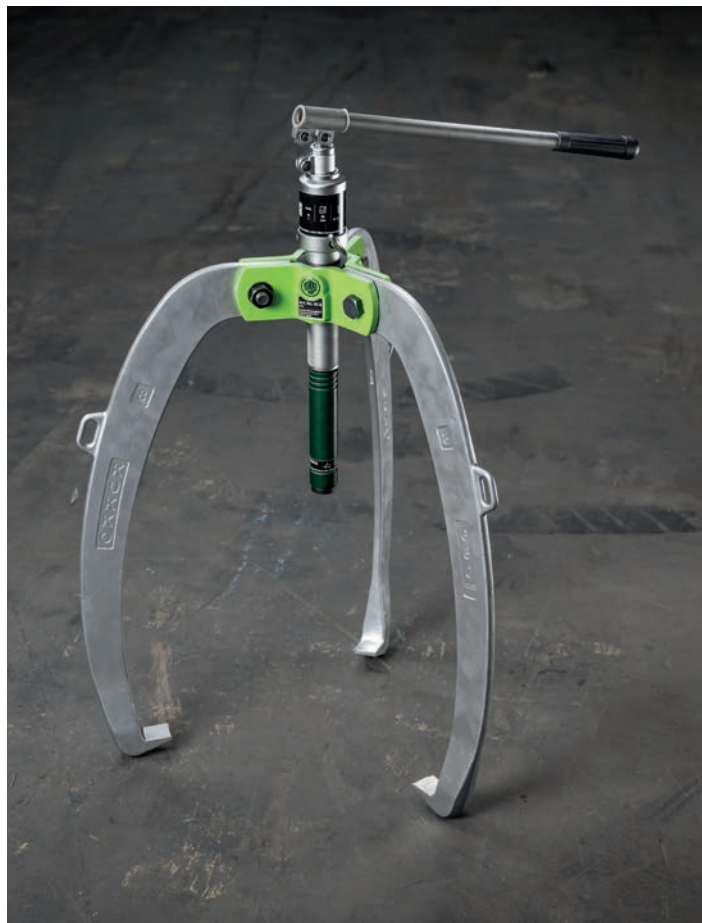
45-8 ze smarowanym wrzecionem hydraulicznym
