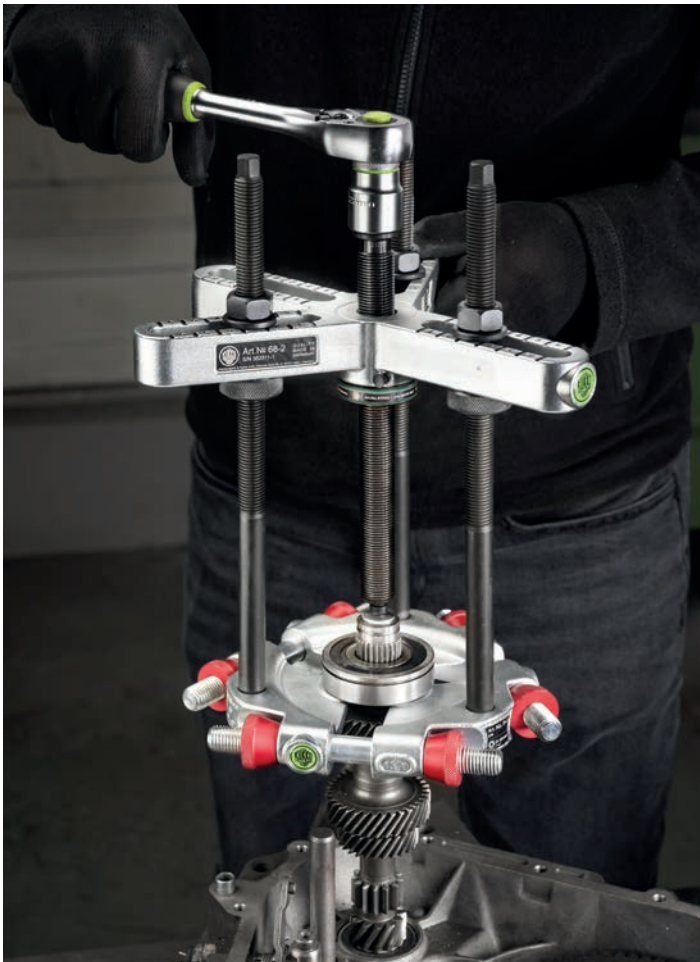
Połączenie TRI-PULL i ściągacza serii 68 do demontażu łożysk kulkowych
