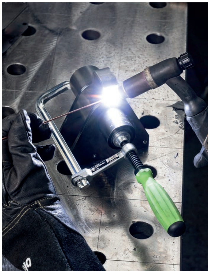
Podczas prac spawalniczych zaciski śrubowe wykonane w całości ze stali działają jak "trzecia ręka"
