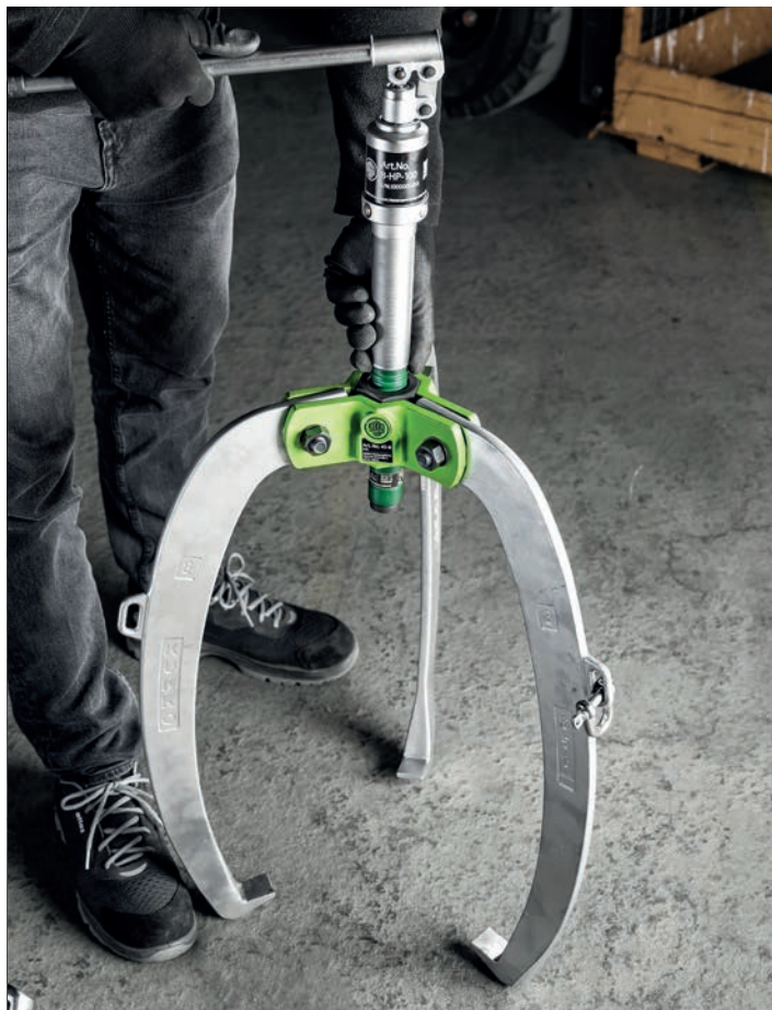
Wkręcanie wrzeciona hydraulicznego w istniejący gwint
