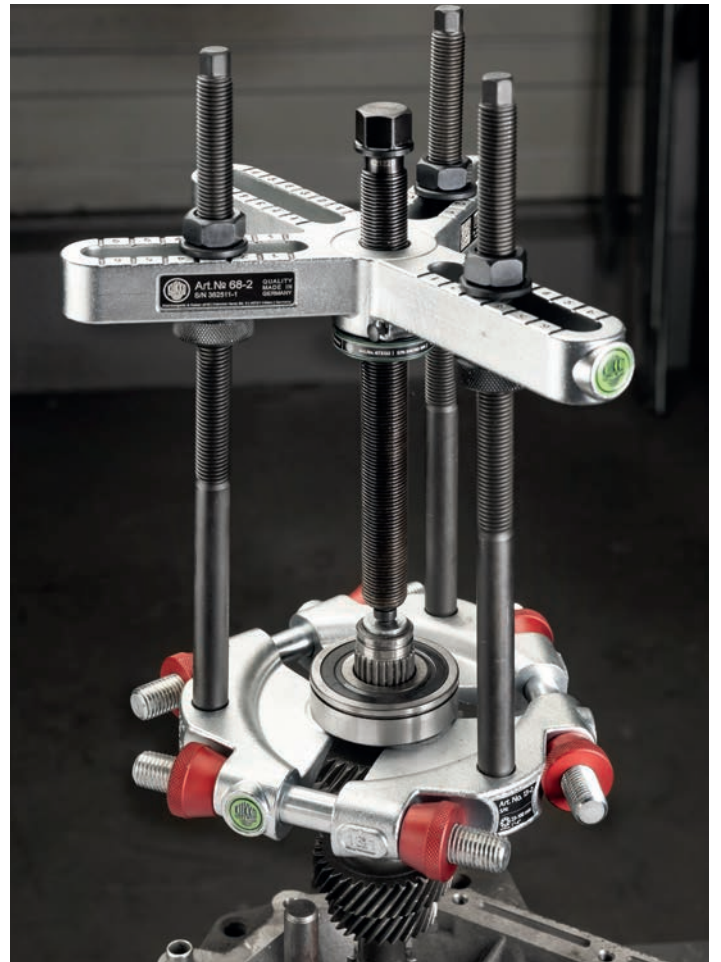
Ściąganie łożyska kulkowego z wału przekładni
